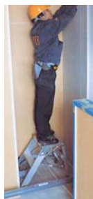
写真はEステップ DES50 87mmの超ワイドステップ (通常40mm)。 疲れにくく、安定性も抜群。
